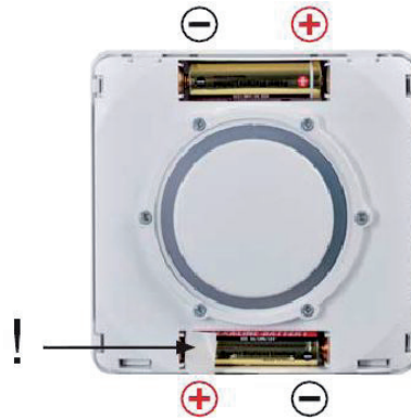
Abb. 9. Entfernen Sie das Isolierpapier vom Batterienkontakt
