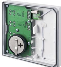
1, Überprüfen Sie die Polarität der Batterien (Abb. 1, 2, 3).
