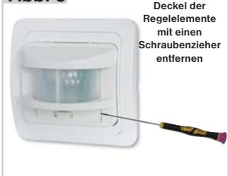
Deckel der Regelemente mit einem Schraubenzieher entfernen
