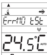
Signalisiert richtigen Anschluss vom Modul und richtige Einstellung vom PIN-Code.
