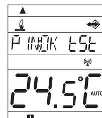
Signalisiert richtigen Anschluss vom Modul, aber die Einstellung vom PIN-Code ist nicht richtig! Modul muss getrennt werden, Steuereinheit muss gelöscht werden und PIN-Code muss richtig eingestellt werden!
