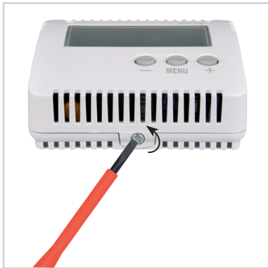
Abb.1 Lösen Sie die Feststellschraube und nehmen Sie den Bedienungsteil vom unteren Gehäuse des Gerätes ab.
