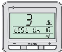
Am Empfänger leuchten gleichzeitig beide LEDs mehrmals auf und es kommt zum mehrmaligen Ein- und Ausschalten des Ausgangsrelais. Auf dem Display erscheint mehrmals abwechselnd „test On / test Off“.
