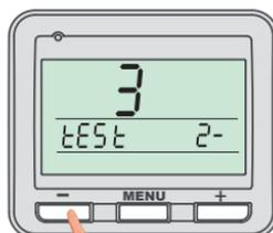
Drücken Sie auf die **-** Taste, wodurch das Signal zum zweiten Empfänger gesendet wird.
