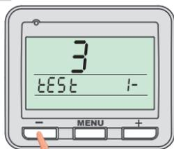
Drücken Sie auf die **-** Taste, wodurch das Signal zum Empfänger gesendet wird.
