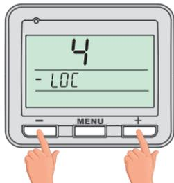
Für die Aktivierung der Funktion wählen Sie mit den **+ / -** Tasten das Symbol **4** und für die Deaktivierung der Funktion wählen Sie das Symbol **-**.
