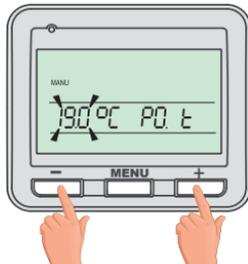
Die Solltemperatur beginnt zu blinken. Über die Taste **+** oder **-** kann die Solltemperatur geändert werden.
